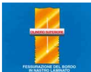
Figura 8 Rappresentazione schematica: Fessurazione del bordo in nastro laminato [da riferimento (10)]
