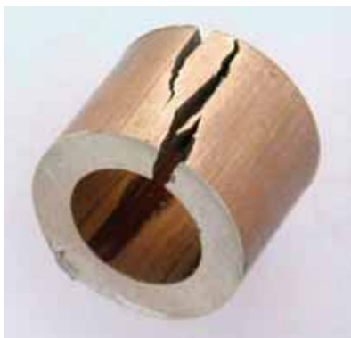
Figura 1 Fessurazione da fuoco in tubo di oro bianco a 18 carati [da riferimento (14)]
