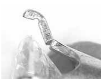
Figura 12 Esempio di fessurazione da tensocorrosione nell'oro a 14 carati [da riferimento (18)]
