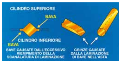
Figura 9 Rappresentazione schematica: Formazione di grinze nella laminazione di un'asta [da riferimento (10)]
