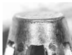
Figura 10 Fessurazione dovuta a lavorazione eccessiva durante lo stampaggio [da riferimento (11)]
