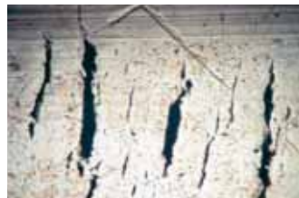
Figura 5 Fessurazione superficiale di un anello ottenuto con fusione in colata continua oro 14 carati [da riferimento (8)]
