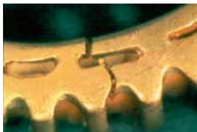
Figura 11 Fessurazione nell'oro a 18 carati dovuta ad infragilimento da silicio [da riferimento (8)]
