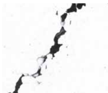
Figura 13 Fessurazione da tempra nell'oro a 9 carati contenente silicio da fusione a cera persa [da riferimento (19)]
